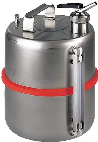
Edelstahl 1.4571 unpoliert Maße: ca. 260 x 340 (D x H in mm) Füllstandsanzeige aus PFA, Flamm Sperre im Behälterhals, selbstschließender Dosierhahn mit Belüftung, manueller Vakuum-/Überdruckausgleich, Behälterkennzeichnung nach GefStoffV und BGV A8.
