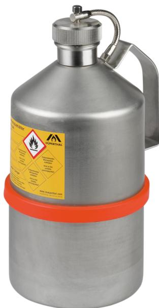
Edelstahl 1.4571 unpoliert Maße: ca. 130 x 270 (D x H in mm) Dichter Verschluss, Deckel unverlierbar an biegsamer Welle, Flamm Sperre im Behälterhals, bauartzugelassenes Gefäß nach ADR, RID und und IMDG-Code, Behälterkennzeichnung nach GefStoffV, BGV A8 und ADR/RID. Prüfungen: BAM-Zulassung
