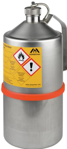
Edelstahl 1.4571 unpoliert Maße: ca. 165 x 380 (D x H in mm) Dichter Verschluss, Deckel unverlierbar an biegsamer Welle, Flamm Sperre im Behälterhals, bauartzugelassenes Gefäß nach ADR, RID und und IMDG-Code, Behälterkennzeichnung nach GefStoffV, BGV A8 und ADR/RID.
