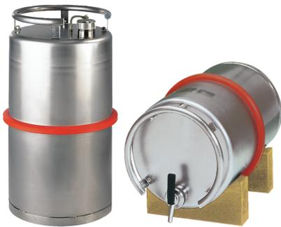
Edelstahl 1.4301 unpoliert Maße: ca. 300 x 530 (D x H in mm) mit umlaufendem Tragegriff, stapelbar, dichter Verschluss, manuelle Belüftung, Deckel unverlierbar an biegsamer Welle, Flamm Sperre im Behälterhals, bauartzugelassenes Gefäß nach ADR, RID, IMDG-Code und ICAO-TI, Behälterkennzeichnung nach GefStoffV, BGV A8 und ADR/RID. Prüfungen: BAM-Zulassung
