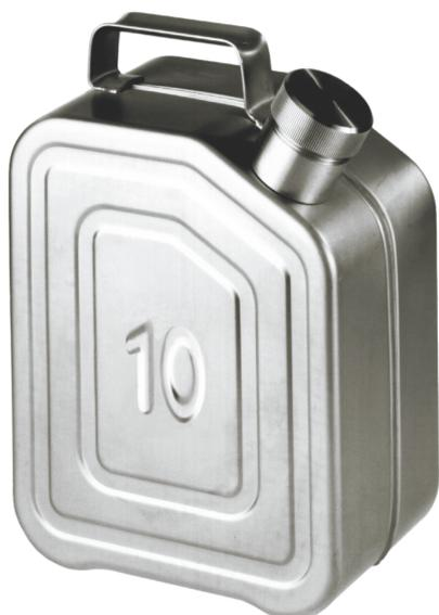
Edelstahl 1.4571 poliert Maße: ca. 130 x 280 x 370 (B x T x H in mm) Dichter Verschluss, Deckel unverlierbar an biegsamer Welle, Flamm Sperre im Behälterhals, bauartzugelassenes Gefäß nach ADR, RID und IMDG-Code, Behälterkennzeichnung nach nach GefStoffV, BGV A8 und ADR/RID. Prüfungen: BAM-Zulassung
