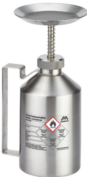
Behälter Edelstahl 1.4571 (AISI 316Ti) poliert Maße: ca. 105 x 273 (D x H in mm) Dichtungen: LDPE ohne Schraubkappe Incl. Tränkeller mit Flamm Sperre und Pumpwerk Edelstahl 1.4301
