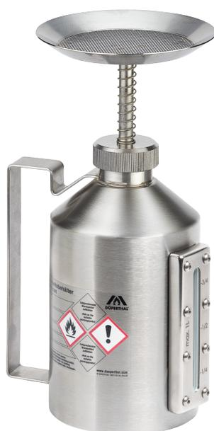
Behälter Edelstahl 1.4571 (AISI 316Ti) poliert Maße: ca. 105 x 273 mm (D x H) Dichtungen: LDPE ohne Schraubkappe für die Verwendung an biegsamer Welle inklusive Deckelarretierung, Flamm Sperre im Behälterhals, Füllstandskontrolle über integriertes Schauglas mit Messskala, Behälterkennzeichnung nach GefStoffV und Arbeitsstättenrichtlinie A1.3 (ASR) vorbereitet. Incl. Tränkeller mit Flamm Sperre und Pumpwerk Edelstahl 1.4301 Tränkeller-Durchmesser: ca. 120 mm
