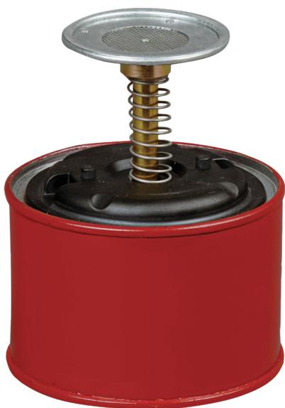
Maße: ca. 120 x 135 (D x H in mm) Tränkeller-Durchmesser: ca. 75 mm, innen zinnbeschichtet, außen pulverbeschichtet rot, Tränkeller mit Flamm Sperre, Pumpwerk aus Messing und PPS, Behälterkennzeichnung nach GefStoffV und BGV A8. Prüfungen: FM-geprüft
