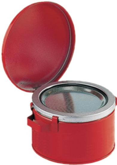
Maße: ca. 120 x 130 (D x H in mm) innen zinnbeschichtet, außen pulverbeschichtet rot, Flamsperre als Tränkteller, Behälterkennzeichnung nach GefStoffV und BGV A8. Prüfungen: FM-geprüft
