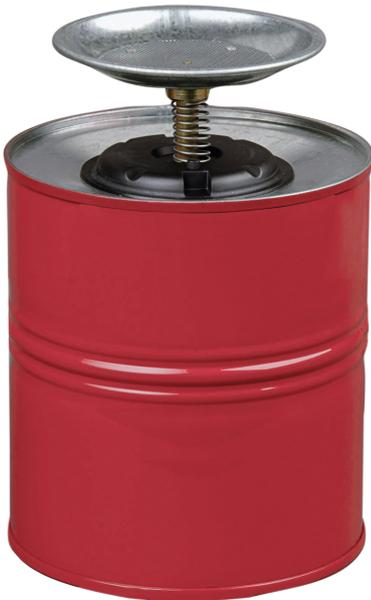
Maße: 180 x 270 (D x H in mm) Tränkeller-Durchmesser: ca. 135 mm innen zinnbeschichtet, außen pulverbeschichtet rot, Tränkeller mit Flamm Sperre, Pumpwerk aus Messing und PPS, Behälterkennzeichnung nach GefStoffV und BGV A8. Prüfungen: FM-geprüft
