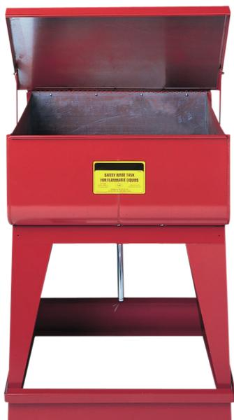
Füllmenge: ca. 48 Liter Außenmaße: ca. 610 x 496 x 845 (B x T x H mm) Becken (innen): ca. 603 x 406 x 222 (B x T x H mm) Becken, Deckel und Untergestell aus verzinktem Stahlblech, rot lackiert. "3/4"-Gewinde im Beckenboden für gezieltes Entleeren. Selbstständiges, langsames Schließen des Deckels über Gasdruckfedern. Prüfung: FM-geprüft.
