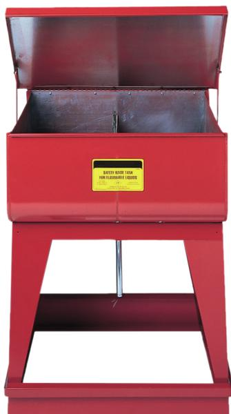
Füllmenge: ca. 2 x 15 Liter Außenmaße: ca. 610 x 496 x 845 (BxTxH mm) Becken (innen): ca. 2x 298 x 406 x 222 (BxTxH mm) Becken, Deckel und Untergestell aus verzinktem Stahlblech, rot lackiert. Für die Reinigung extrem verschmutzter Teile. Vorreinigung in der 1. Kammer, Endreinigung in der 2. Kammer. "3/4"-Gewinde je Kammer im Beckenboden für gezieltes Entleeren. Prüfung: FM-geprüft.
