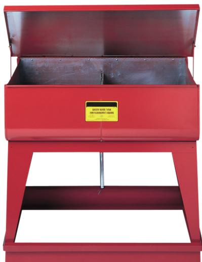
Füllmenge: ca. 2 x 34 Liter Außenmaße: ca. 895 x 496 x 845 (BxTxH mm) Becken (innen): ca. 2x 438 x 406 x 305 (BxTxH mm) Becken, Deckel und Untergestell aus verzinktem Stahlblech, rot lackiert. Für die Reinigung extrem verschmutzter Teile. Vorreinigung in der 1. Kammer, Endreinigung in der 2. Kammer. "3/4"-Gewinde je Kammer im Beckenboden für gezieltes Entleeren. Prüfung: FM-geprüft.
