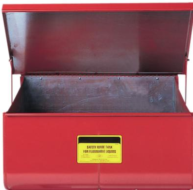
Füllmenge: ca. 48 Liter Außenmaße: ca. 610 x 496 x 273 (B x Tx H mm) Becken (innen): ca. 603 x 406 x 222 (B x T x H mm) Zum Aufstellen auf die Werkbank. Becken und Deckel aus verzinktem Stahlblech, rot lackiert. Deckel im Brandfall selbstschließend. "3/4"-Gewinde im Beckenboden für gezieltes Entleeren. Prüfung: FM-geprüft.
