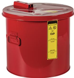
Maße: ca. 360 x 360 (D x H in mm) außen pulverbeschichtet rot, innen zinnbeschichtet, Deckel im Brandfall selbstschließend mittels Schmelzsicherung, Behälterkennzeichnung nach GefStoffV und BGV A8. Prüfungen: FM/UL-geprüft
