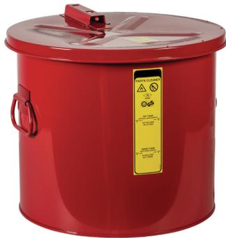
Maße: ca. 410 x 390 (D x H in mm) außen pulverbeschichtet rot, innen zinnbeschichtet, Deckel im Brandfall selbstschließend mittels Schmelzsicherung, Behälterkennzeichnung nach GefStoffV und BGV A8. Prüfungen: FM/UL-geprüft
