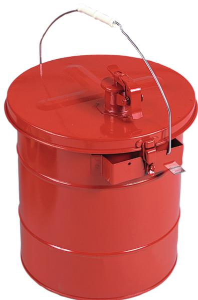
Maße: ca. 380 x 405 (D x H in mm) Inhalt: ca. 19 Liter Stahlblech, innen zinnbeschichtet, außen pulverbeschichtet rot, selbstschließende Einfüllöffnung mit Flamm Sperre, Behälterdeckel fest verschließbar, automatischer Überdruckausgleich, mit Erdungsglasche.
