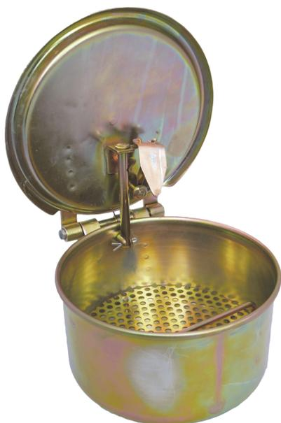
inkl. Teilekorb Maße: ca. 150 x 80 (D x H in mm) Deckel im Brandfall selbstschließend mittels Schmelzsicherung, Behälterkennzeichnung nach GefStoffV und BGV A8.
