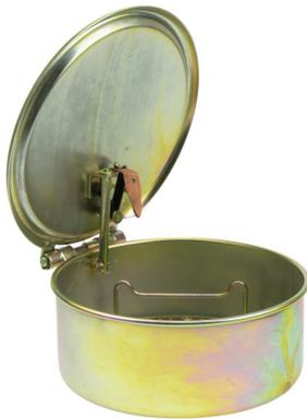
inkl. Teilekorb Maße: ca. 230 x 100 (D x H in mm) Deckel im Brandfall selbstschließend mittels Schmelzsicherung, Behälterkennzeichnung nach GefStoffV und BGV A8.
