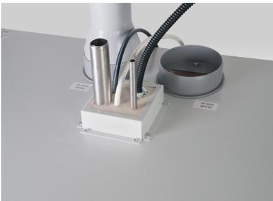
Modell SUPPLY: alle Größen Modell COMPLEX: alle Größen Modell DISPOSAL: alle Größen Modell DISPOSAL UTS/DISPOSAL UTS ergo: alle Größen Bauseitige Montage für die Durchführung von: Rohren, Kabeln oder Schläuchen Außenmaße: 120x120x34 (BxTxH) Nutzbare Fläche: 80x80 Farbe: lichtgrau elektr. ableitfähig Anbauposition und max. Durchbruchquerschnitt nach Anbauanweisung. Keine Gewährleistung bei bei Abweichungen zur Anbauanweisung
