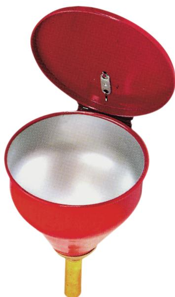
Einfülldurchmesser: ca. 280 mm Länge Flamm Sperre: ca. 150 mm Trichter außen pulverbeschichtet rot, innen zinnbeschichtet, Tauchrohr/ Flamm Sperre aus Messing, 2 " Gewinde, Deckel im Brandfall selbstschließend mittels Schmelzsicherung Prüfung: FM-GEPRÜFT
