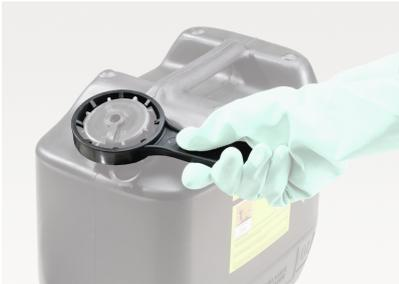
Material: komplett aus Kunststoff (schwarz) Hinweis: Um den dichten Verschluss der Verschraubung zu gewährleisten, muss diese mit einem Drehmoment von 20 Nm zuge dreht werden.
