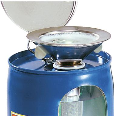
Einfüllöffnung 180 mm Durchmesser, mit Sägewinde S 56 x 4, Überfüllsicherung, Klappdeckel, PE-Dichtung, Flamm Sperre Edelstahl (austauschbar), 2 Griff flaschen, Erdungskette (300 mm lang) aus Edelstahl, Anschluss für Erdungskabel unterhalb des Deckelscharniers, in Verbindung mit Kanister wird ein Überfüllen verhindert, Kennzeichnung nach GefStoffV und BGV A8.
