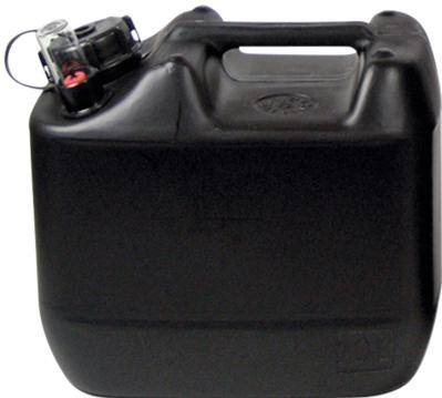
Zum Sammeln und innerbetrieblichen Transport von brennbaren Flüssigkeiten. Kanister aus schwarzem Polyethylen, elektrisch leitfähig, recyclebar. Einfüllöffnung Ø 56 mm Füllstandsanzeige warnt vor Überfüllung. Hohe Medienbeständigkeit. Behälterkennzeichnung nach GefStoffV und BGV A8 vorbereitet.
