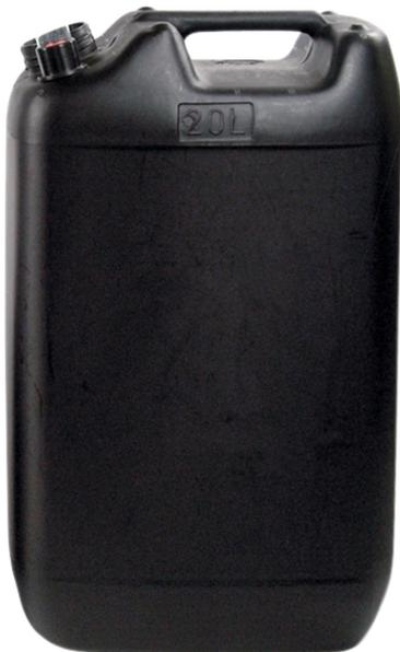
Zum Sammeln und innerbetrieblichen Transport von brennbaren Flüssigkeiten. Kanister aus schwarzem Polyethylen, elektrisch leitfähig, recyclebar. Einfüllöffnung Ø 56 mm Füllstandsanzeige warnt vor Überfüllung. Hohe Medienbeständigkeit. Behälterkennzeichnung nach GefStoffV und BGV A8 vorbereitet.
