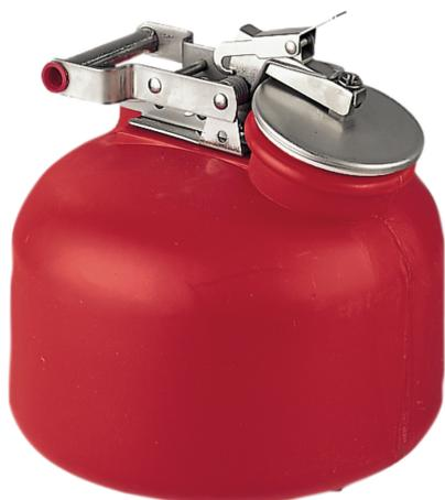
Maße: ca. 310 x 350 (D x H in mm) Deckel selbstschließend, arretierbar, große Einfüllöffnung D = 90 mm, Armaturen aus Edelstahl, Erdungsanschluss im Griff mit Flamm Sperre (im Behälterhals) verbunden, Behälterkennzeichnung nach GefStoffV und BGV A8. Prüfung: FM-GEPRÜFT
