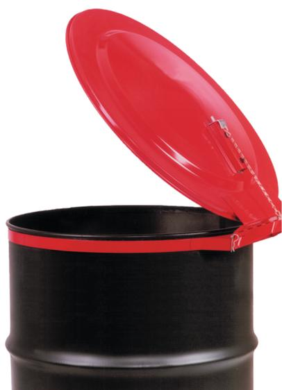
rot pulverbeschichtet, Deckel im Brandfall selbstschließend mittels Schmelzsicherung, Behälterkennzeichnung nach GefStoffV und BGV A8. Prüfungen: FM-GEPRÜFT
