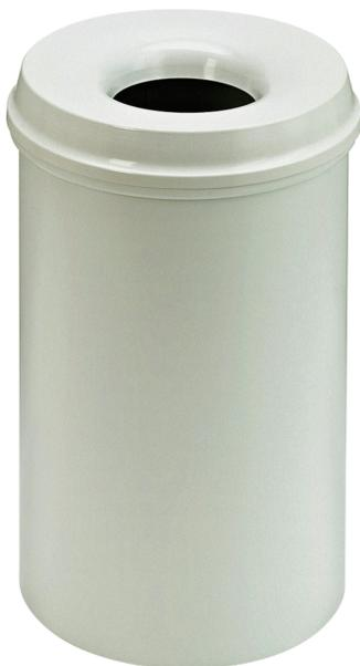
Maße: ca. 260 x 426 (D x H mm), Behälter und Löschkopf aus Stahlblech, lichtgrau RAL 7035, Löschkopfkonstruktion verhindert im Brandfall die Sauerstoffzufuhr, Prüfung: GS-ZEICHEN
