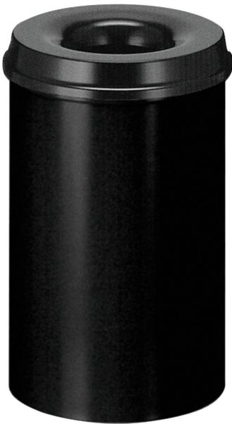
Maße: ca. 260 x 426 (D x H mm), Behälter und Löschkopf aus Stahlblech, schwarz RAL 9011, Löschkopfkonstruktion verhindert im Brandfall die Sauerstoffzufuhr, Prüfung: GS-ZEICHEN
