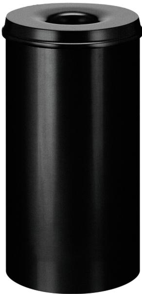
Maße: ca. 335 x 625 (D x H mm), Behälter und Löschkopf aus Stahlblech, schwarz RAL 9011, Löschkopfkonstruktion verhindert im Brandfall die Sauerstoffzufuhr.
