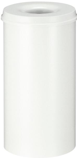
Maße: ca. 335 x 625 (D x H mm), Behälter und Löschkopf aus Stahlblech, weiß RAL 9002, Löschkopfkonstruktion verhindert im Brandfall die Sauerstoffzufuhr.
