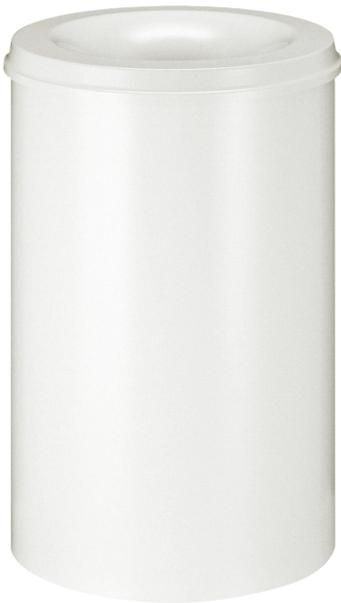
Maße: ca. 450 x 710 (D x H mm), Behälter und Löschkopf aus Stahlblech, weiß RAL 9002, Löschkopfkonstruktion verhindert im Brandfall die Sauerstoffzufuhr.
