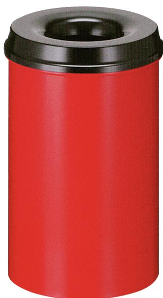
Maße: ca. 260 x 426 (D x H mm), Behälter und Löschkopf aus Stahlblech, Löschkopf schwarz RAL 9011, Behälter rot RAL 3000, Löschkopfkonstruktion verhindert im Brandfall die Sauerstoffzufuhr, Prüfung: GS-ZEICHEN
