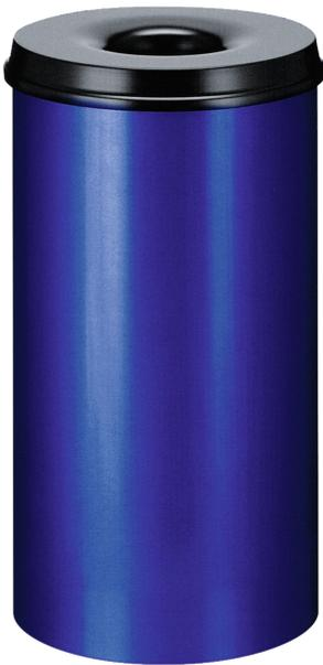
Maße: ca. 335 x 625 (D x H mm), Behälter und Löschkopf aus Stahlblech, Löschkopf schwarz RAL 9011, Behälter blau RAL 5013, Löschkopfkonstruktion verhindert im Brandfall die Sauerstoffzufuhr.
