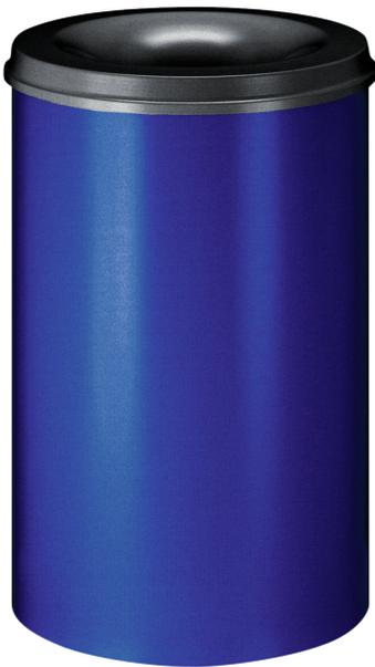
Maße: ca. 450 x 710 (D x H mm), Behälter und Löschkopf aus Stahlblech, Löschkopf schwarz RAL 9011, Behälter blau RAL 5013, Löschkopfkonstruktion verhindert im Brandfall die Sauerstoffzufuhr.
