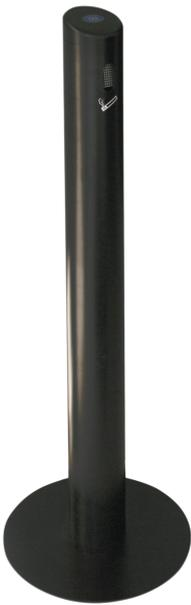
Maße: ca. 356 x 1041 (D x H in mm), Inhalt ca. 3 l pulverbeschichtete Aluminium-/Stahlkonstruktion, glimmende Zigarettenkippen werden selbstständig gelöscht, integriertes Sicherheitssieb verhindert, dass Glut und Asche wieder heraus fallen, abgedeckte Öffnung schützt vor Regen.
