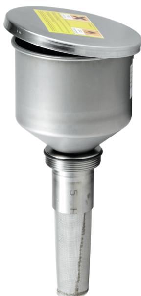
Einfüllöffnung 120 mm Durchmesser, mit G2 " Rohrgewinde (G2 " Muffe mit 2 " Tri-Sure-Stopfen) inkl. Viton-Dichtung, Überfüllsicherung, Klappdeckel. NUR in Verbindung mit Flamm Sperre Artikel 5E10.004 oder 5.88.003 einsetzbar! In Verbindung mit Behälter wird ein Überfüllen verhindert. Kennzeichnung nach GefStoffV und BGV A8.
