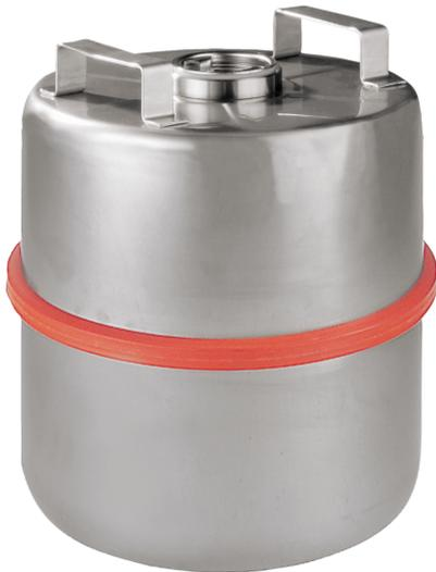
Edelstahl 1.4571 unpoliert, Maße: ca. 280 x 290 (D x H in mm) G2 " Muffe mit 2 " Tri-Sure-Stopfen inkl. Viton-Dichtung, ohne Flamm Sperre, Behälterkennzeichnung nach GefStoffV und BGV A8.
