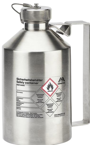
Edelstahl 1.4571 (AISI 316Ti) poliert Maße: ca. 100 x 210 mm (D x H) Dichtungen: LDPE Dichter Verschluss, Deckel unverlierbar mit zusätzlicher Halterung. Flamm Sperre im Behälterhals. Behälterkennzeichnung nach GefStoffV und Arbeitsstättenrichtlinie A1.3 (ASR) vorbereitet.
