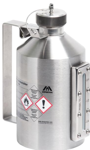
Edelstahl 1.4571 (AISI 316Ti) poliert Maße: ca. 100 x 210 mm (D x H) Dichtungen: LDPE Dichter Verschluss, Deckel unverlierbar an biegsamer Welle inkl. Deckelarretierung. Flamm Sperre im Behälterhals, Füllstandskontrolle über integriertes Schauglas mit Messskala, Behälterkennzeichnung nach GefStoffV und Arbeitsstättenrichtlinie A1.3 (ASR) vorbereitet.
