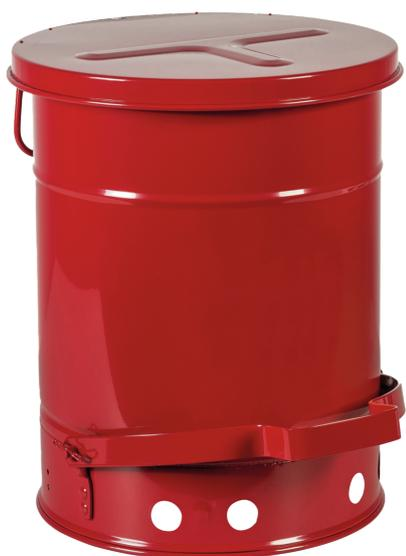
Maße: ca. 290 x 397 (D x H mm), Stahlblech, außen pulverbeschichtet rot, innen zinnbeschichtet, selbstschließender Deckel wird über Fußpedal geöffnet, Behälterkennzeichnung nach GefStoffV und BGV A8. Prüfungen: FM/UL-geprüft
