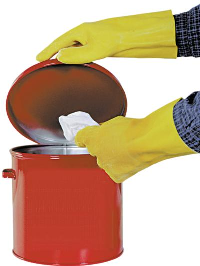
Maße: ca. 245 x 230 (D x H in mm) Stahlblech, außen pulverbeschichtet rot, innen zinnbeschichtet, ohne gelochten Bodenrand, mit seitlichen Tragegriffen, selbstschließender Deckel, Öffnung per Hand, Behälterkennzeichnung nach GefStoffV und BGV A8. Prüfung: FM-geprüft
