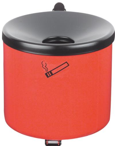
Sicherheits-Wandaschenbecher aus Stahlblech, Behälter pulverbeschichtet, rot Einwurftrichter lackiert, schwarz Maße (Ø x H) ca. 150 x 145 mm Volumen ca. 2,4 Liter Trichterförmige Deckelöffnung verhindert im Brandfall die Sauerstoffzufuhr, aufgrund der Löschkopfkonstruktion werden glimmende Zigarettenkippen selbstständig gelöscht. einfaches Entleeren, mit Wandhalterung.
