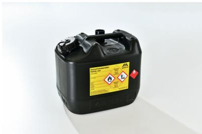
schwarz, elektrostatisch leitfähig, Maße: 298 x 198 x 264 (L x B x H) in mm mit eingeschweißter Sensorhalterung z.B. für kapazitiven Füllstandssensor (I/O)
