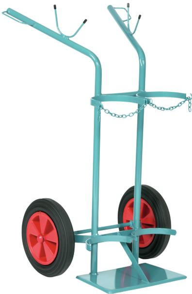
mit Vollgummireifen. Geeignet für den Transport von 2 x 50-Liter-Druckgasflaschen. Stahlrohrkonstruktion, blau lackiert. Inklusive Kettensicherung. Tragkraft 200 kg. Maße (B x T x H): ca. 770 x 780 x 1350 mm
