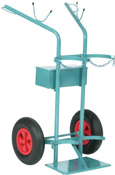
mit Vollgummireifen. Geeignet für den Transport von 2 x 50-Liter-Druckgasflaschen. Stahlrohrkonstruktion, blau lackiert. Inklusive Kettensicherung. Mit verschließbarem Werkzeugkasten. Maße (B x T x H): ca. 770 x 780 x 1350 mm
