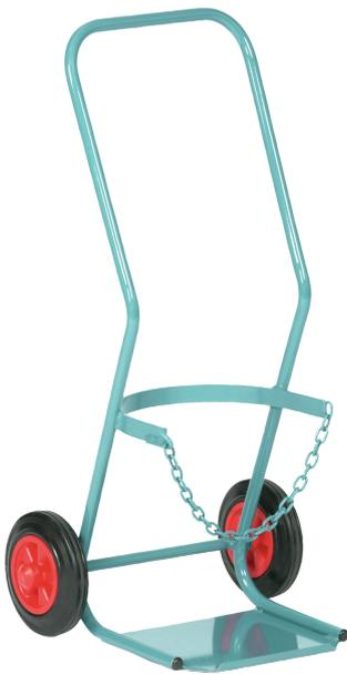
mit Vollgummireifen. Maximale Anzahl Propangasflaschen: 1 x 33 kg. Stahlrohrkonstruktion, blau lackiert. Inklusive Kettensicherung. Sicheres Greifen über roten PVC-Handgriff. Maße (B x T x H): ca. 485 x 550 x 1050 mm
