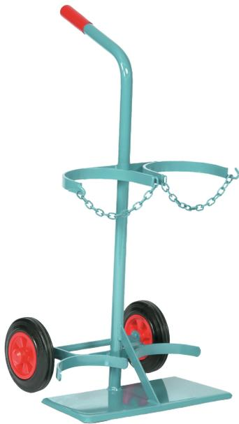
mit Vollgummireifen. Geeignet für den Transport von 2 x 20-Liter-Druckgasflaschen. Stahlrohrkonstruktion, blau lackiert. Inklusive Kettensicherung. Sicheres Greifen über roten PVC-Handgriff. Maße (B x T x H): ca. 530 x 500 x 1050 mm
