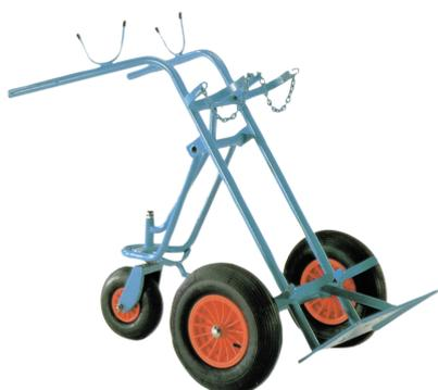
mit Vollgummireifen und ausklappbarem Spornrad. Geeignet für den Transport von 2 x 50-Liter-Druckgasflaschen. Stahlrohrkonstruktion, blau lackiert. Inklusive Kettensicherung. Sicheres Greifen über Handschutzbügel. Maße (B x T x H): ca. 770 x 800 x 1350 mm
