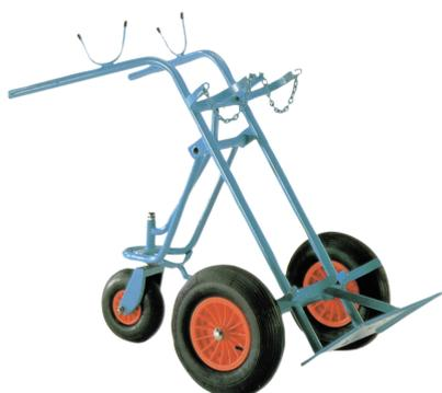
mit Vollgummireifen und ausklappbarem Spornrad. Geeignet für den Transport von 2 x 50-Liter-Druckgasflaschen. Stahlrohrkonstruktion, blau lackiert. Inklusive Kettensicherung. Sicheres Greifen über Handschutzbügel. Mit verschließbarem Werkzeugkasten, großem Schlauch- und Brennerhalter und Schweißdrahtbehälter 2-fach. Maße (B x T x H): ca. 770 x 800 x 1600 mm
